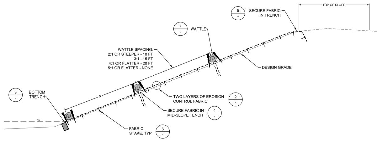
1 EROSION CONTROL FABRIC SECTION VIEW NOT TO SCALE
